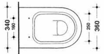
ART. 30 - Vaso normale ELIOS con scarico a pavimento o a parete. Peso Kg. 19
